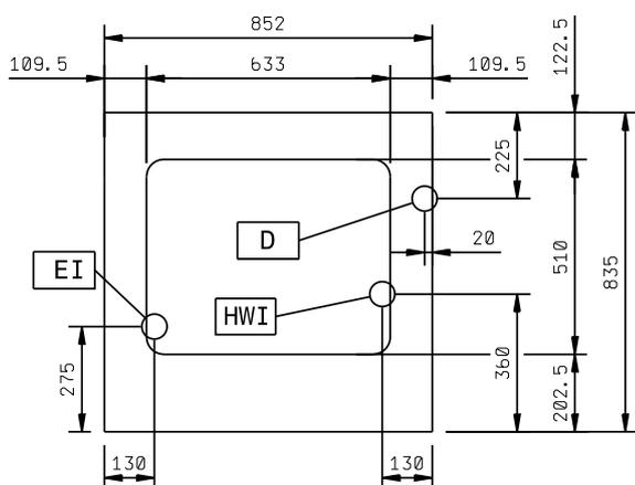
**D** = Scarico acqua      **HWI** = Attacco acqua calda
